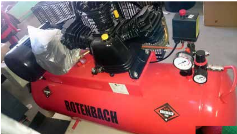
Compresor de tres pistones
